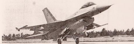
F-16 lander i Stauning - den behøver kun halvdelen af den 1450 meter lange bane, for den lander med 180 km/t. Men ude over Nordsøen kan den flyve op til 2000 km/t.
