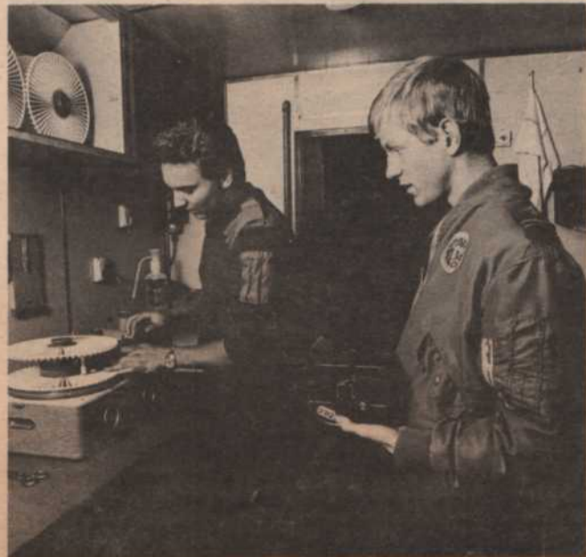
Filmen bliver fastgjort i fremkalderrullen inden den går i tanken
