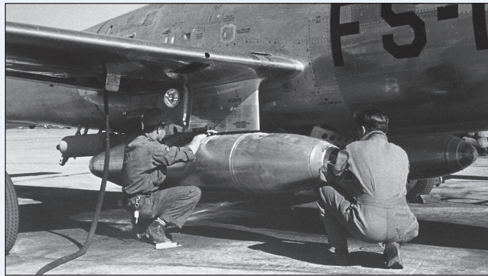
F-84G oplades med napalm bombe på Luke AFB. Bemærk JATO-bottlen til venstre under bagkroppen. Foto: via FER.
