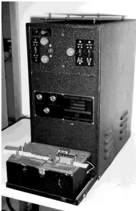
ETCRRM, produceret på Standard Telefon- og Kabelfabrik i Oslo. Det første on-line kryptoudstyr, der blev taget i brug i Flyvevåbnet.
