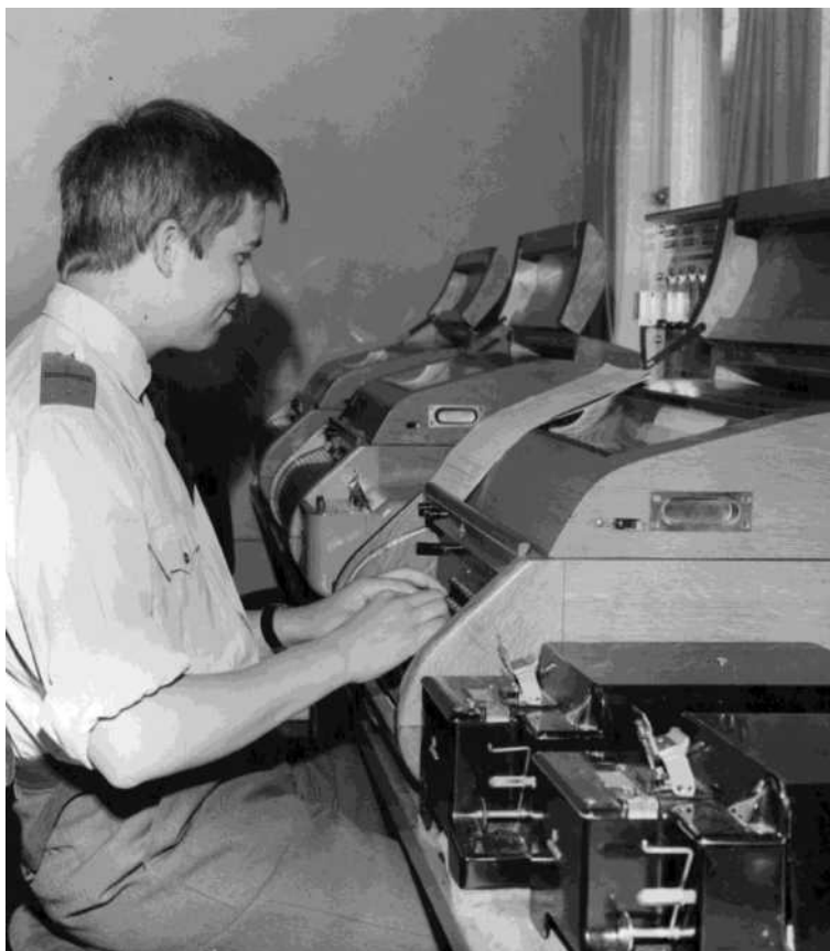
Samme operatør betjener en Siemens T100 fjernskriver, der er anbragt i en støjdæmpende kasse.
