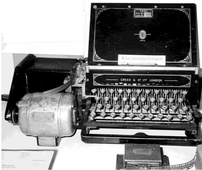
Creed klaviaturperforator, der anvendtes til at fremstille hulstrimler. Ved hjælp af sådanne kunne morsetegnene, bl.a. øvelsesudsendelserne fra Jonstrup, udsendes automatisk af en morsetransmitter med valgbar hastighed.
