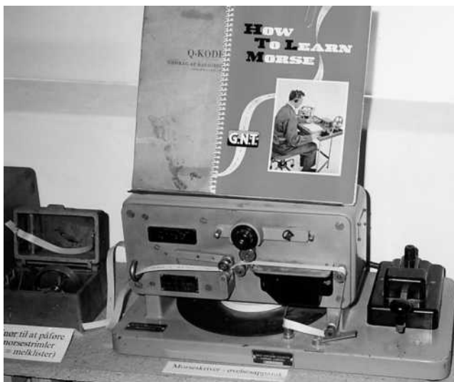
GNT morseskriver, anvendt til træning og prøver. Morsetegnene blev gengivet på papirstrimmel, der blev oplæbet på papir og afleveret til bedømmelse.
