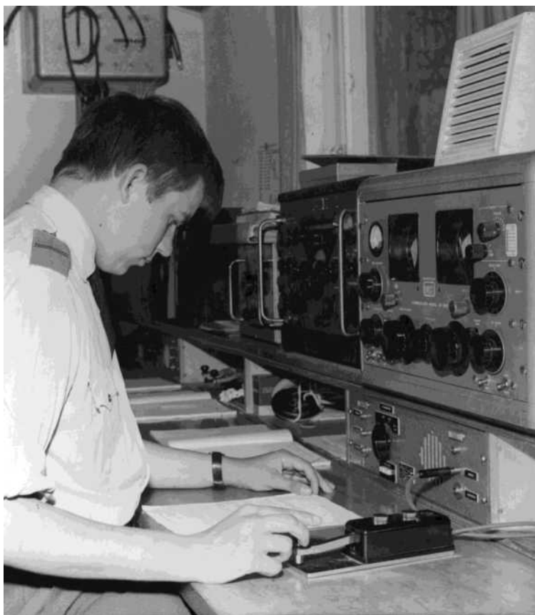
Konstabel Sørensen, Signaltjenesten på Flyvestation Skrydstrup, 1967. I forgrunden en Hammarlund SP-600 ved siden af en Collins R-388. På væggen ses antenneskab med mulighed for at skifte modtagerantenne øst-vest/nord-syd.
