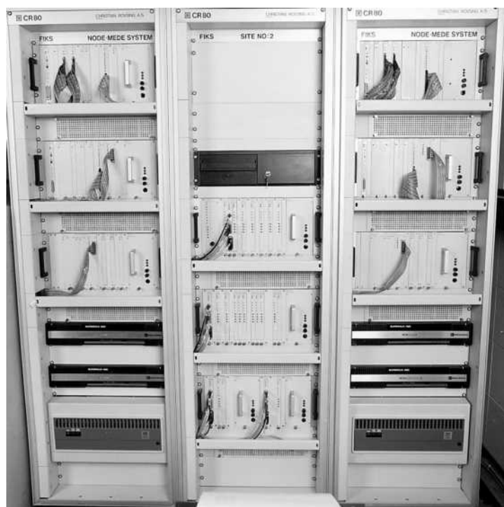
MEDE computer og stand-by computer. I midten watchdog-computer og forbindelser til terminaler. Nederst de store og, efter datidens forhold, kraftige harddiske med 80 Mb lager.
