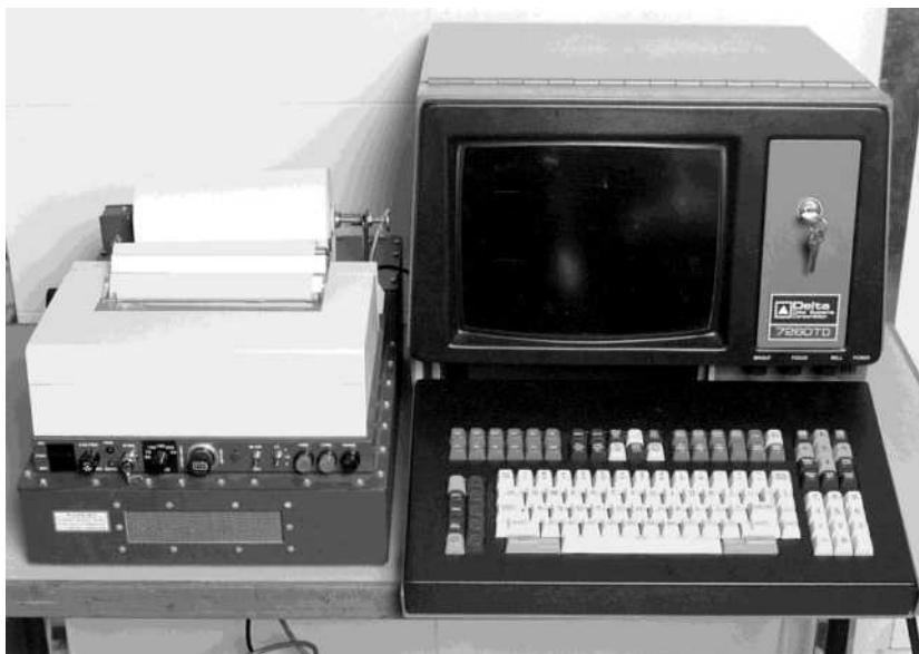
Delta VDU og printer. Tempest-foseglet terminal til Comcentre.
