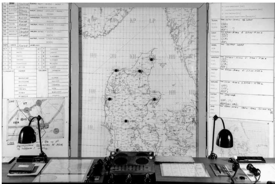
Landkortet i Fighter Marshall hvor lysstråler fra fixerstationerne markerer retning til flyet.
