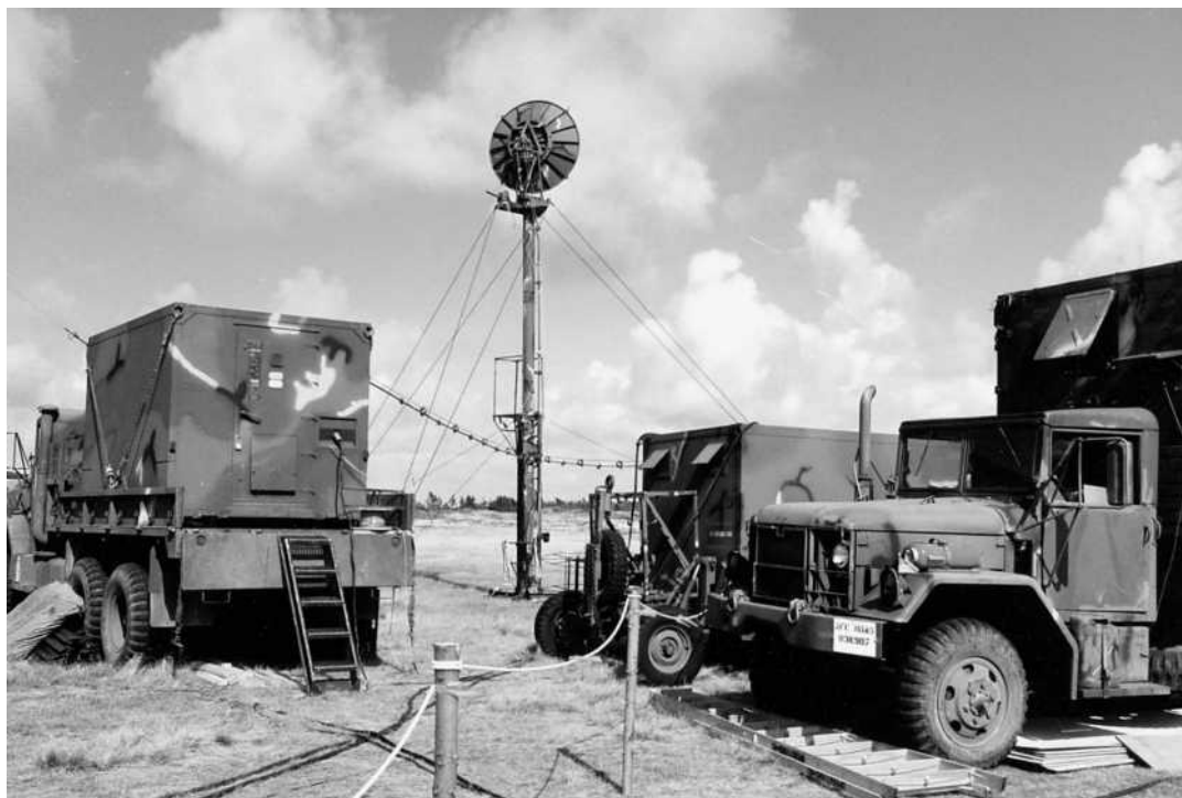
GSQ-120 antenne til overførsel af radarbillede fra hundborg.
