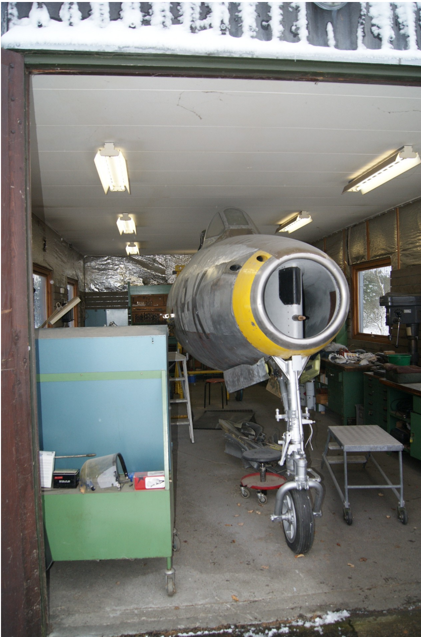
Det meste af fuselagen, bagkroppen mangler, i det lille værksted ved motorprøvestanden. Næsehjulsbenet med næsehjul er rette op og monteret igen.
